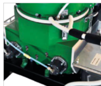
Клапан ограничения давления со встроенным фильтром тонкой очистки
