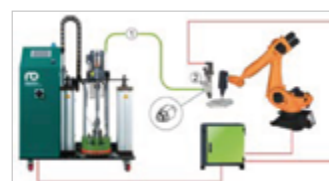
Система нанесения при помощи робота
